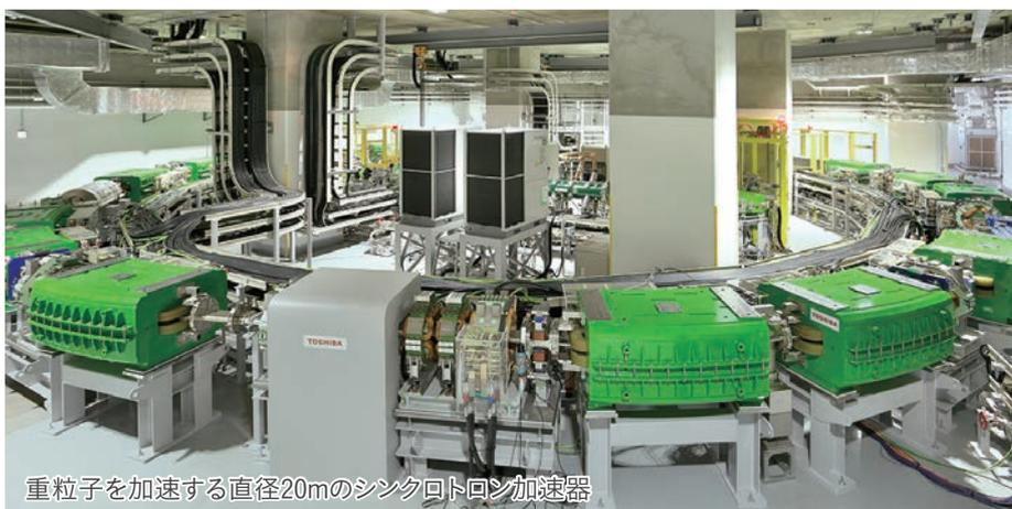
重粒子を加速する直径20mのシンクロトロン加速器
