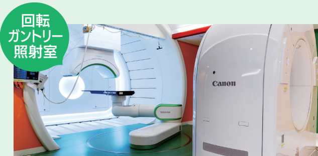
世界3台目となる重粒子線回転ガントリー照射装置です。装置が回転し最適な角度から治療部位にピンポイントで重粒子線を照射しますので、患者さんは楽な姿勢のまま治療を受けていただけます。
